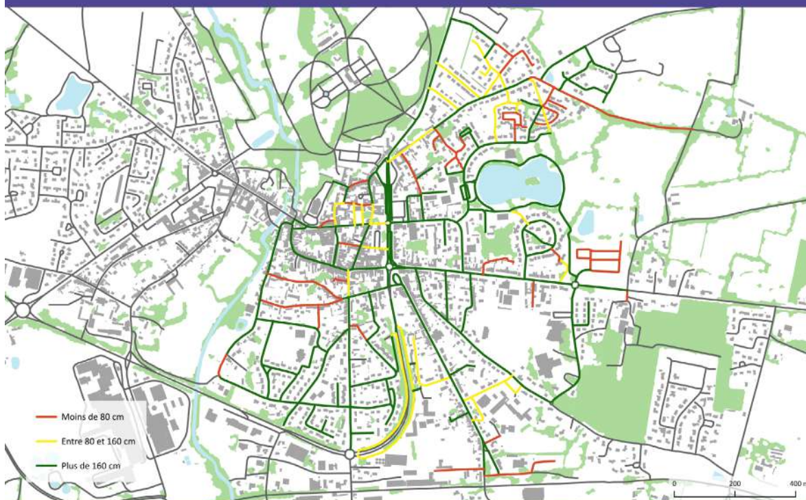
Largeur des cheminements piétons à Craon
