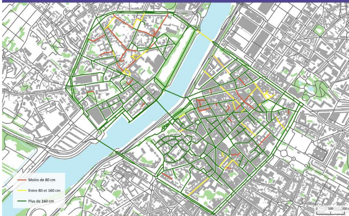
Largeur des cheminements piétons à Angers
